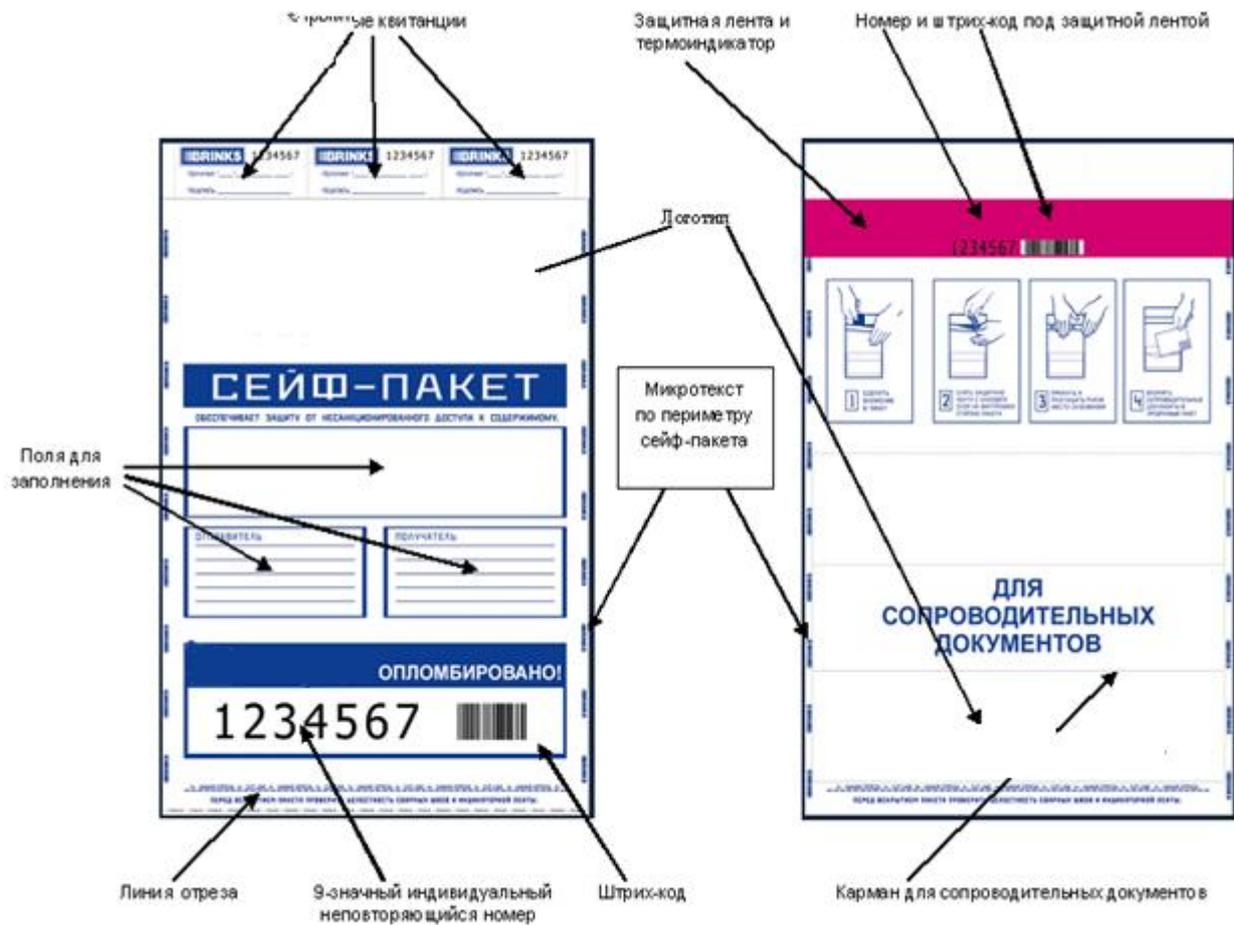
1. Специальная лента безопасности технологически разработана так, чтобы визуально легко выявить любую попытку вмешательства (на рисунке 1 - защитная лента). Термоиндикатор обеспечивает защиту от воздействия и применения нагревательных приборов.
